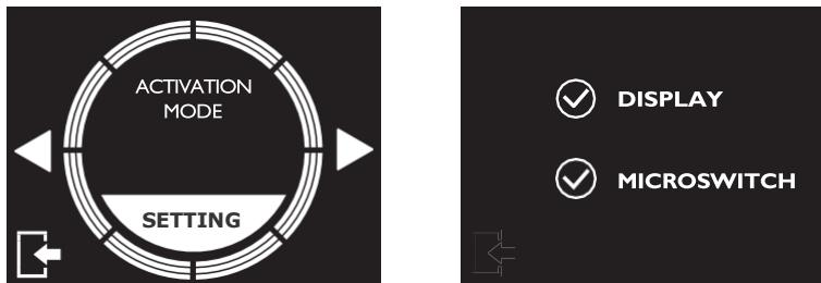
Nach dem Drücken der SETTING-Taste können Sie wählen, ob Sie das Mahlen aktivieren durch Drücken der Dosiertaste auf dem Display (B,L,C,H) oder über die Mahlgradaktivierungstaste
